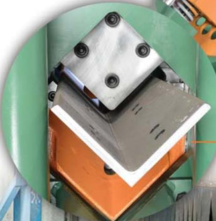
Einfacher Scherschnitt oder doppelter Schälschnitt
